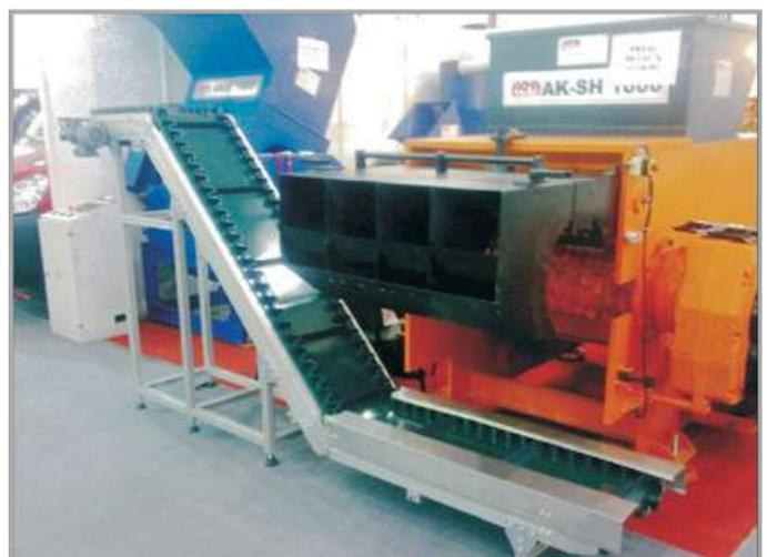
Schnelle Fertigung kann mit Profilen erfolgen, die speziell für jede Art von Förderbändern entworfen wurden. Förderbänder werden in der gewünschten Größe hergestellt.
